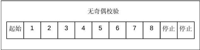
图 8: RTU 模式位序列 (无校验的特殊情况)
